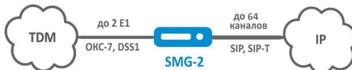
Рисунок 2 – Сопряжение сигнализаций и медиапоточков TDM- и VoIP-сетей с использованием SMG-2
