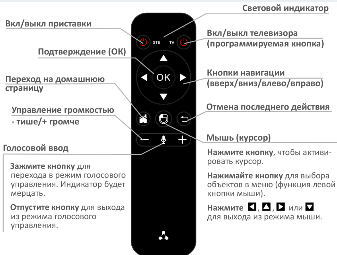
Рисунок 7 – Универсальный Bluetooth-пульт дистанционного управления медиацентром и телевизором
