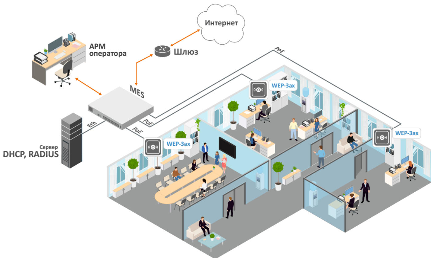
Рисунок 1 – Функциональная схема использования WEP-3ax
